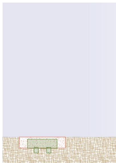
Phase 1 : Coulage de la semelle de fondations et des pieux supports
